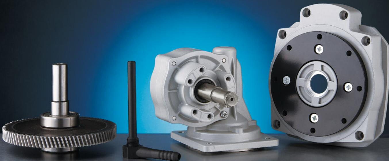
●转子轴材料采用40Cr，齿部粗滚后高频淬火HRC50-55，硬齿面二次刮削，齿轮精度可达ISO 6-7级。●轴齿轮材料采用20CrMnTi,齿部粗滚后渗碳淬火HRC58-61，硬齿面二次刮削，齿轮精度可达ISO 6-7级。●盘齿轮材料采用40Cr，齿部粗滚后高频淬火HRC48-51，磨齿，齿轮精度可达ISO 6-7级。
